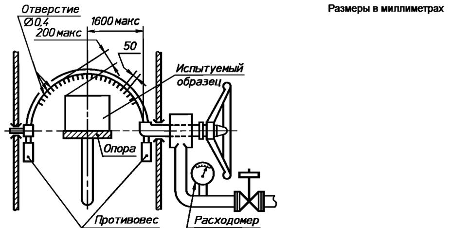
Примечание — Распределение, отверстий, как для второй характеристической цифры 3 [см. 14.2.3, перечисление а)].
